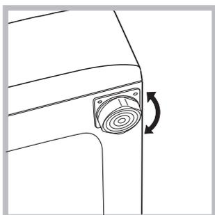
2. Sollte der Boden nicht perfekt eben sein, müssen die Unebenheiten durch An- bzw. Ausdrehen der vorderen Stellfüße ausgeglichen werden (siehe Abbildung), der auf der Arbeitsfläche zu ermittelnde Neigungsgrad darf 2° nicht überschreiten.
