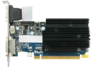
Sapphire 11233-01-20G. Grafikprozessorenfamilie: AMD, GPU: Radeon R5 230, Prozessor-Taktfrequenz: 625 MHz. Separater Grafik-Adapterspeicher: 1 GB, Grafikkartenspeichertyp: GDDR3, Speichertaktfrequenz: 1334 MHz. Maximale Auflösung: 1920 x 1200 Pixel. DirectX-Version: 11, Dual-Link-DVI. Schnittstelle: PCI Express x16. Kühlung: Passiv
