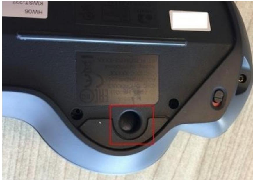
3. Wischen Sie die Steuerkugel und die weißen Gleitlager ab, um sämtliche Staubrückstände aus dem Kugellager und von der Steuerkugel zu entfernen.
