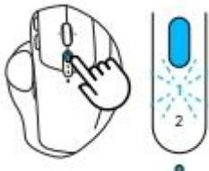
4. Halten Sie die Easy-Switch-Taste drei Sekunden lang gedrückt, um in den Pairing-Modus zu schalten. Die LED beginnt zu blinken.
