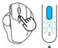
5. Halten Sie die Easy-Switch-Taste drei Sekunden lang gedrückt, um in den Pairing-Modus zu schalten. Die LED beginnt zu blinken.
