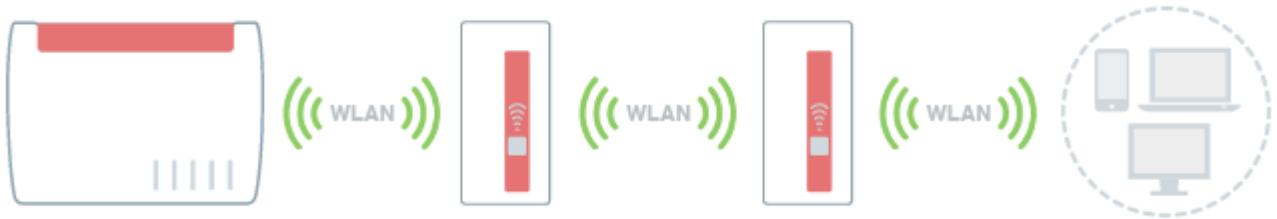
Abb.: WLAN-Reihenschaltung (Kaskadierung) von zwei FRITZ!WLAN Repeatern
