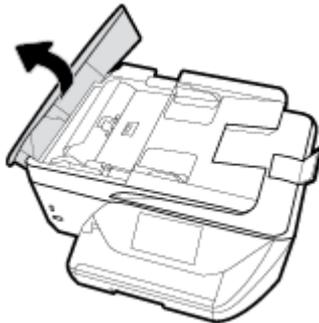
Dadurch erhalten Sie einfachen Zugang zu den Walzen (1) und zum Trennblock (2).
