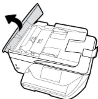
2. Heben Sie die Arretierung an der vorderen Kante des Vorlageneinzugs an.
