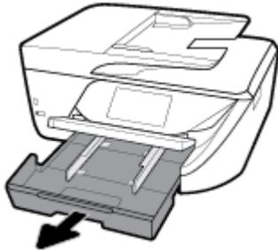
3. Schieben Sie die Papierquerführungen bis zum Anschlag nach außen.
