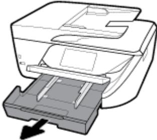
3. Legen Sie das Papier mit der Druckseite nach unten in die Mitte des Fachs und schieben Sie es bis zum Anschlag nach vorne.
