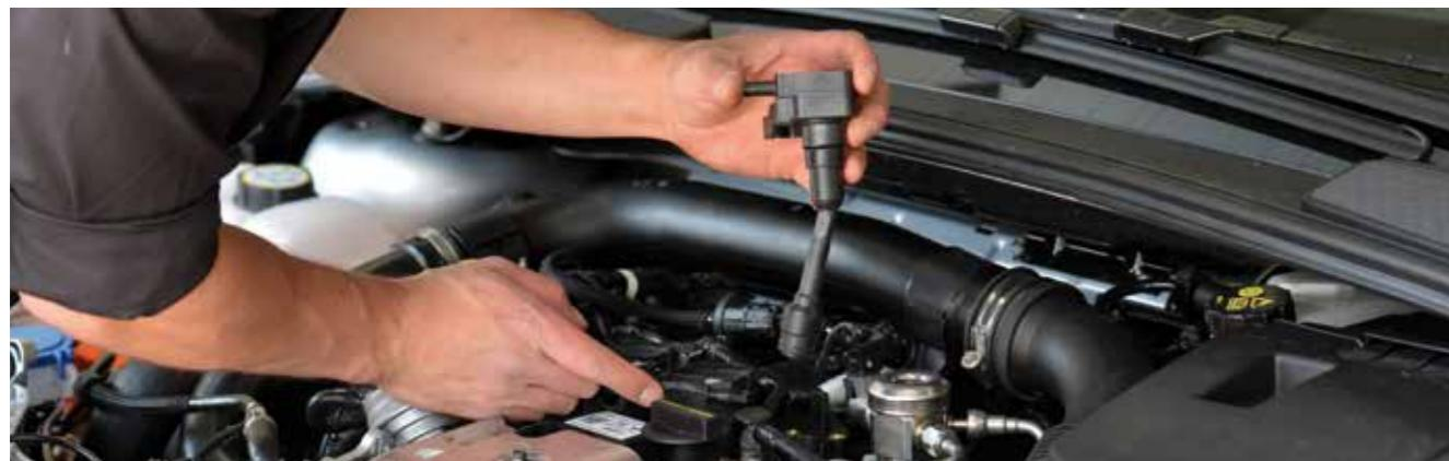
Wie viele andere Bauteile eines Fahrzeugs unterliegt auch die Zündspule einem gewissen Verschleiß. Ihre Laufleistung beträgt in der Regel zwischen 60.000 und 80.000 Kilometern – allerdings kann eine Vielzahl von Faktoren zu einer geringeren Lebensdauer führen.
