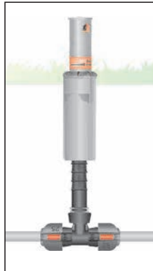
Alternative 2 T-Stück mit 3/4" Innengewinde 25 mm Art. 2790 32 mm Art. 2791 und Verlängerungsrohr 3/4" x 1/2" Art. 2742 oder 3/4" x 3/4" Art. 2743
