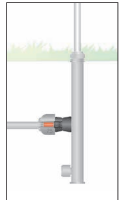
Anschluss Versenkregner S 80/300 Verbinder mit 3/4" Innengewinde 25 mm Art. 2761 32 mm Art. 2767
