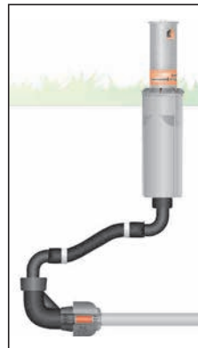
Alternative 1 L-Stück mit 3/4" Innengewinde 25 mm Art. 2784 32 mm Art. 2785 mit flexiblem Regneranschluss 3/4" x 1/2" Art. 2739 oder 3/4" x 3/4" Art. 2740
