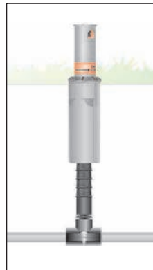
Alternative 6 Anbohrschelle mit 3/4" Innen- gewinde 25 mm Art. 2728 32 mm Art. 2729 und Verlängerungsrohr 3/4" x 1/2" Art. 2742 oder 3/4" x 3/4" Art. 2743
