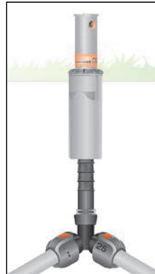
Alternative 3 Winkelstück 25 mm mit 3/4" Innen- gewinde Art. 2764 und Verlängerungsrohr 3/4" x 1/2" Art. 2742 oder 3/4" x 3/4" Art. 2743
