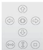
Sie können über das Bedienfeld verwenden, um die Kamera über den Kopf schwenken und neigen. Sie können auch eine horizontale oder vertical starten oder die Kamerabewegung stoppen. Die Kamera wird in den beiden Streifen in die entsprechenden Endpositionen bewegen und dann kehren in die Ausgangsposition zurück.
