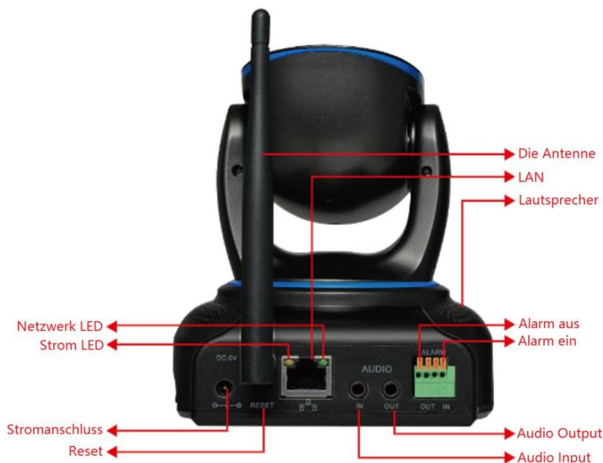
Die Hinteransicht besteht aus einem DC 5V/1.5A Stromanschluss, RJ-45 / 10-100 Basis T Port, Strom und Netzwerk Kontrolllampe, Input/output audio Abflussloch für externe Lautsprecher oder Mikrofon, Alarm ein und Alarm aus für externes Alarmgeräte.
