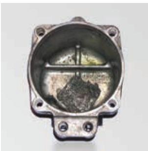
Abrieb bei Kompressorschaden
